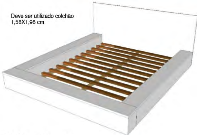
Topo em MDF com revestimento melaminico
